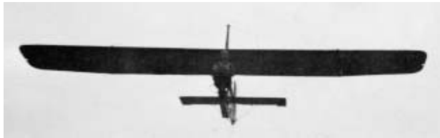
La silhouette caractéristique du SG 38 en vol : mât haubané, tendeurs qu'il fallait vérifier soigneusement avant chaque vol. Ci-dessous, le 30.9.1945 : Hubert Muller sanglé sur le SG 38, prêt pour un lancer au sandow. A l'arrière plan, le chariot pour déplacer le planeur.
