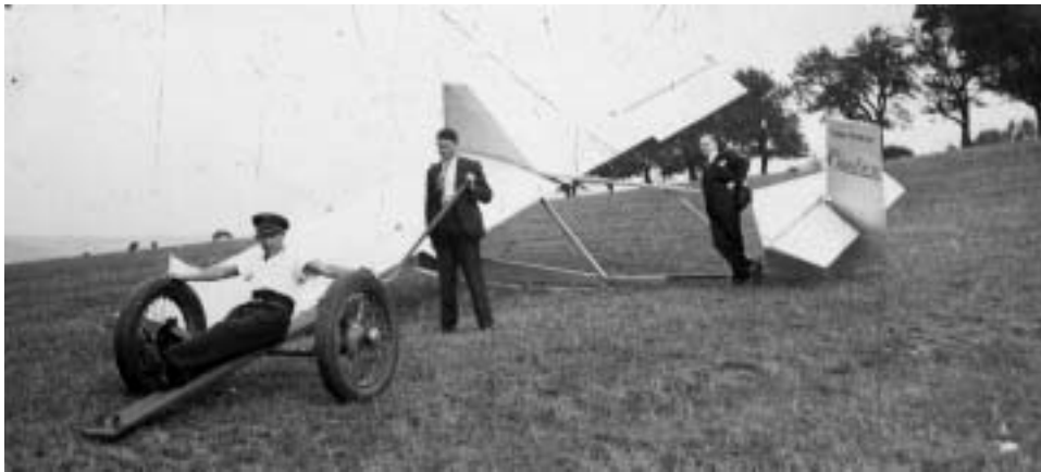
AVIA 11A sur la côte de Guentrange. Notez l'imposant chariot pour le léger Avia 11A ! Après chaque lancer, il fallait aller chercher le planeur au bas de la côte, le hisser sur son chariot et remonter le tout au sommet de la côte pour un nouveau vol d'une dizaine de secondes. Seuls les "mordus" persévéraient ! A la barre du chariot : Jean Nicard.
